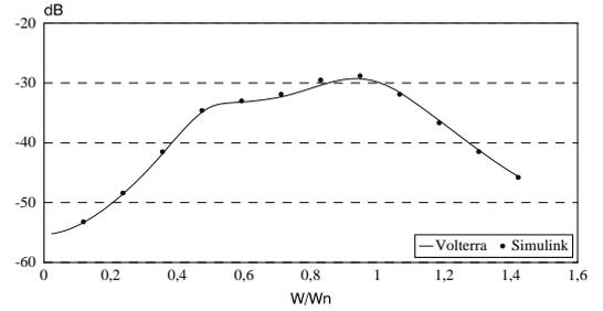
Fig. 6 - Comparação da 2ª harmônica da tensão de saída em ordem à frequência usando simulação por Volterra e no domínio do tempo
