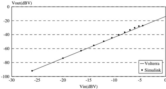
Fig. 4 - Comparação da 3ª harmônica da tensão de saída usando simulação por Volterra e no domínio do tempo
