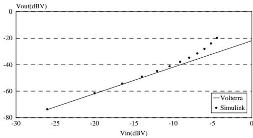
Fig. 3 - Comparação da 2ª harmônica da tensão de saída usando simulação por Volterra e no domínio do tempo
