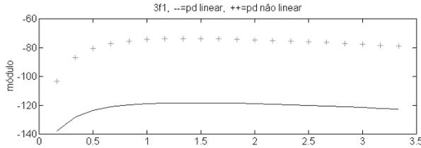
Fig. 8 - Comparação da distorção harmônica não linear de 3ª ordem entre PD linear e PD não linear.
