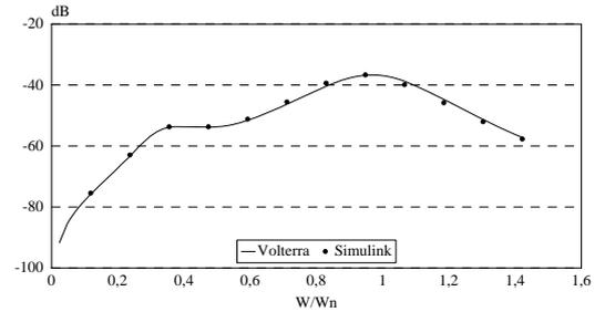
Fig. 7 - Comparação da 3ª harmônica da tensão de saída em ordem à frequência usando simulação por Volterra e no domínio do tempo
