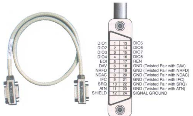
Fig. 3 - Cabo GPIB (esquerda) e ficha GPIB com as respectivas linhas (direita).
