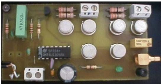
Fig. 9 - Comutador de corrente ultra-rápido.
