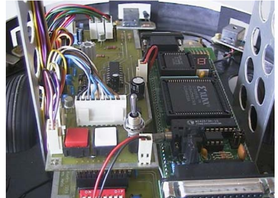
Figura 4 – Localização das placas de controlo, expansão e interface.
