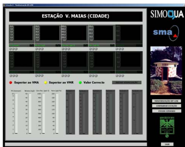
Figura 4 – Visualizador disponível para cada estação remota instalada para a visualização em tempo real dos parâmetros recolhidos.
