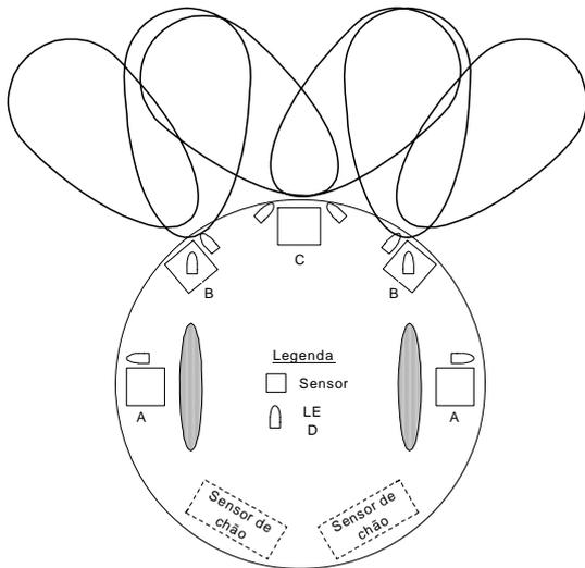
Fig. 3 – Implantação dos sensores de obstáculos
