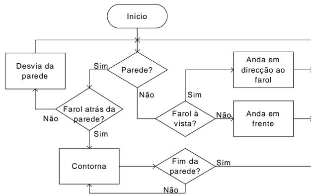
Fig. 10 – Algoritmo de contorno de parede
