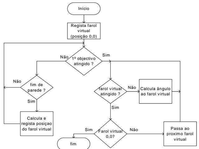
Fig. 13 – Algoritmo de aplicação de faróis virtuais
