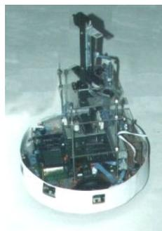
Fig. 1 – O aspecto físico do Bulldozer
