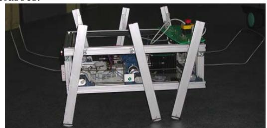
Fig. 1 - O robot com sistema de locomoção inicial
