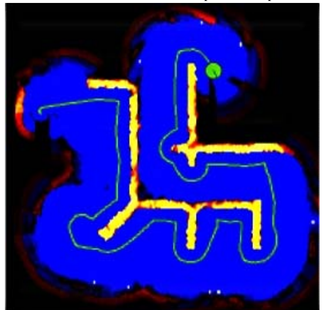
Fig. 3 – Exemplo de mapa de paredes. A azul estão as zonas com pouca probabilidade de ter parede e a amarelo as que têm forte probabilidade de serem paredes. O percurso do robot está marcado a verde. (YAM-viewer)
