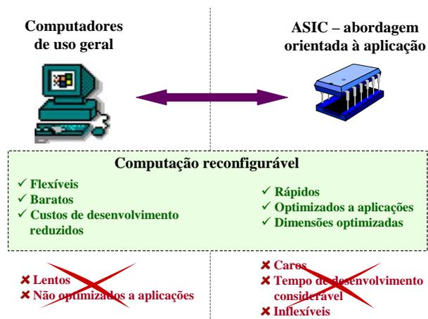
Fig. 1 – Computação reconfigurável combina vantagens principais de computadores de uso geral e de circuitos integrados orientados à aplicação e permite eliminar as suas desvantagens principais
