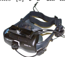
Fig. 1 - HMD com sensor de orientação e micro-câmara
