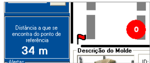
Figura 4 - Leitura da distância de um molde ao ponto de referência
