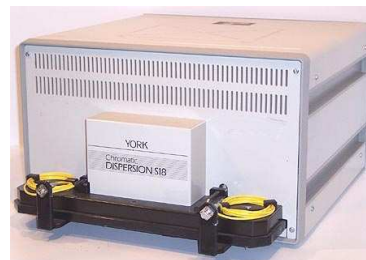
Fig. 8: Equipamento de teste usado na medição da dispersão cromática.
