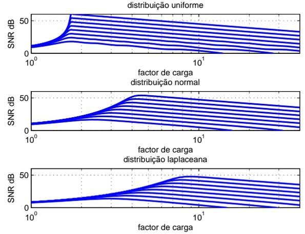
Fig. 3 - Curvas de distorção em função do factor de carga para quantificadores uniformes de 3 a 10 bits e para sinais com distribuição uniforme, normal e laplaceana
