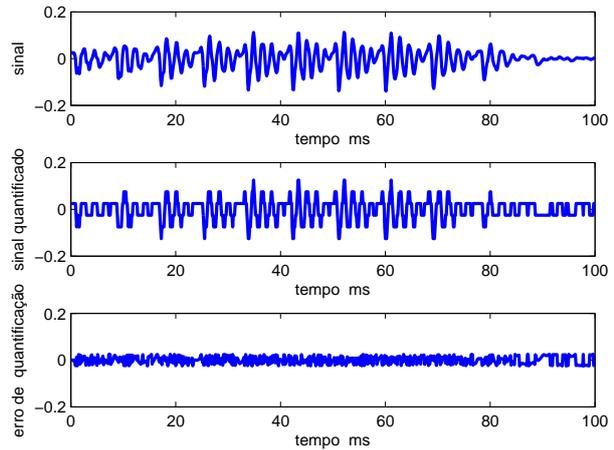
Fig. 2 - Aplicação de um quantificador uniforme de 3 bits a um sinal; sinal, sinal quantificado e erro de quantificação
