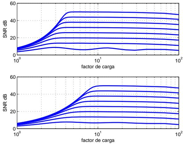
Fig. 8 - Curvas de distorção em função do factor de carga para quantificadores não uniformes de 3 a 10 bits,  $\mu = 255$  e para sinais com distribuição normal e laplaceana
