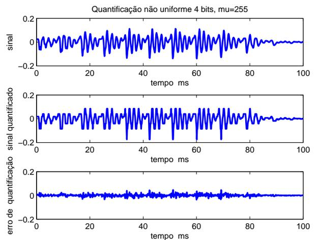
Fig. 7 - Qplicação de um quantificador não uniforme de 4 bits,  $\mu = 255$  a um sinal: sinal quantificado e erro de quantificação
