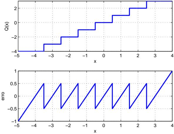
Fig. 1 - Aplicação de um quantificador uniforme de 3 bits a um sinal; sinal, sinal quantificado e erro de quantificação
