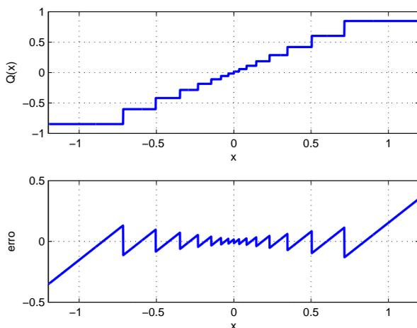
Fig. 6 - Quantificador não uniforme de 4 bits função de transferência e erro de quantificação
