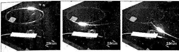
Figura 11- Sequência de imagens da propagação do efeito rastilho numa fibra SMF (o intervalo temporal entre as imagens é de 0.7 s).
