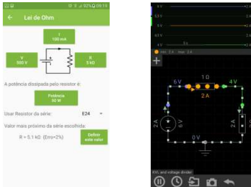
Figura 6 – À esquerda, frame do ElectroDroid aplicando a primeira lei de ohm, identificando até mesmo a potência elétrica consumida pelo resistor teoricamente. À direita, frame do aplicativo EveryCircuit simulando um circuito real identificando em cores suas diversas correntes elétricas na parte inferior e na parte superior suas tensões elétricas consumidas em cada resistor (na prática é o exercício visto na figura 5).
