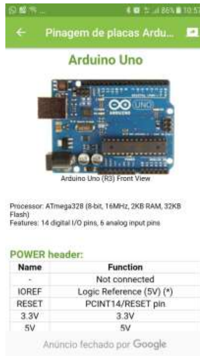
Figura 4 – Identificação de pinagens no Arduino Uno R3
