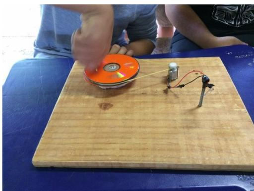
Figura 1 – Exeperimento de utilização de CD antigos para construção de gerador de energia
