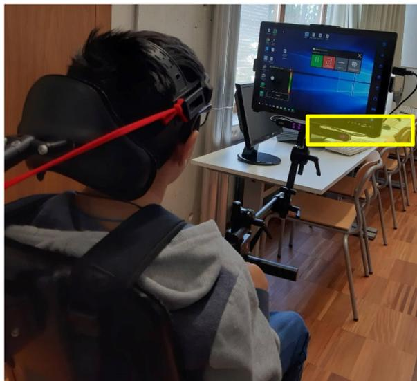
Figura 6. Setup em funcionamento. Distância olhos-computador. Destaque do PCEYE mini.
