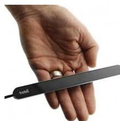
Figura 3. Dispositivo de acesso e controlo pelo movimento dos olhos *PC EYE Mini* - câmara que permite aos utilizadores o acesso ao computador através do olhar, fazendo-se a seleção de itens pela fixação ou piscar dos olhos.
