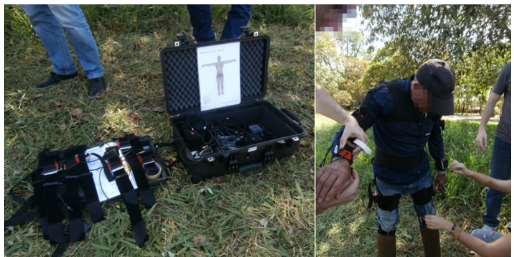
Figura 2. À esquerda: Tecnologia 3D de captura de movimentos por inércia. À direita: instalação do equipamento ao corpo do operador de roçadeira.
