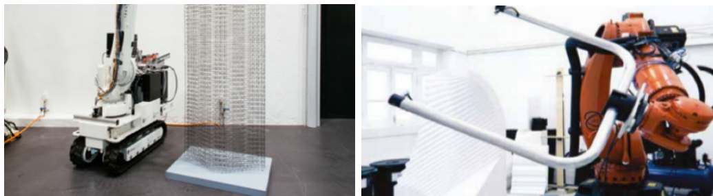
Figura 8. Impressora 3d e robô In Situ Fabricator Robot, do ETH Zurich Dfab, com funcionamento a base de FDM (à esquerda). Braço robótico ligado à impressão 3d, da Universidade do Porto (à direita). Fonte: WANGLER et al., 2016; FONSECA DE CAMPOS; LOPES, 2017.
