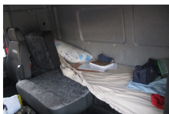
Figura 3. Cama gaúcha com banco de passageiro original (C25).
