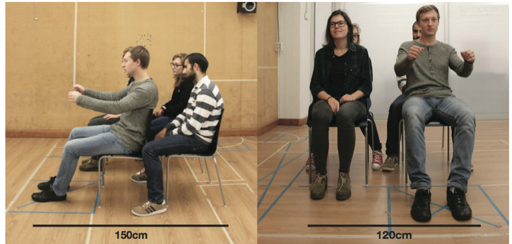
Figura 5. Estudo das dimensões mínimas de um habitáculo para quatro pessoas
