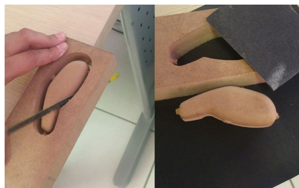
Figura 8. Remoção das pontes de usinagem
