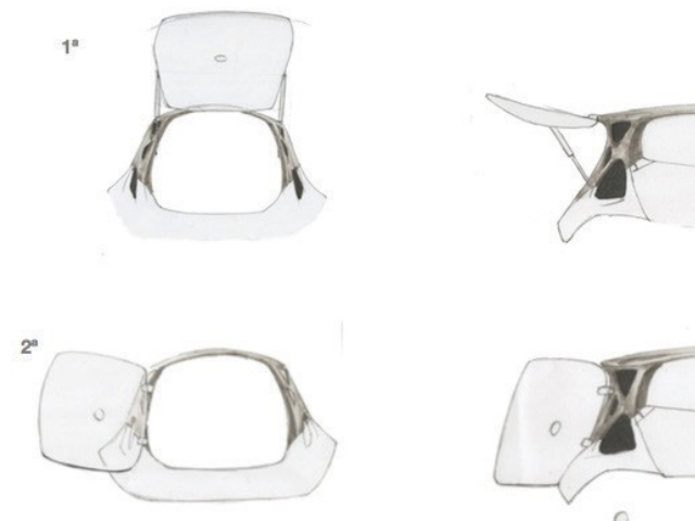
Figura 9. Desenhos de análise morfológica do sistema de abertura da bagageira
