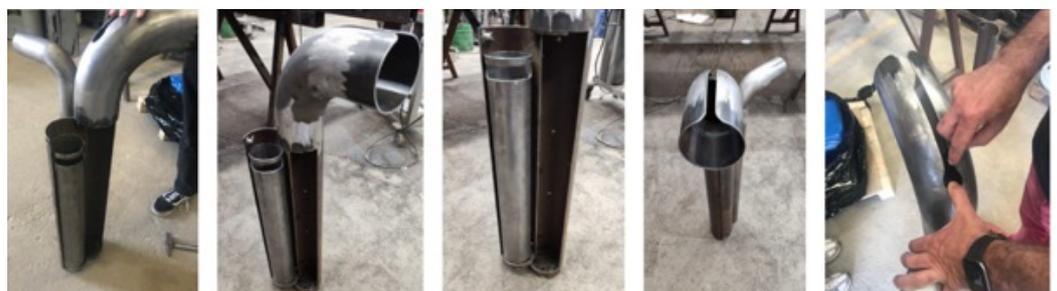
É de salientar que, no desenvolvimento do protótipo tornou-se necessário realizar modificações, visando a manutenção do contentor. Foi necessário a inclusão de uma peça que limite a entrada de lixo comum no contentor, ou seja, projetar um bocal próprio para o contentor. Esta peça foi produzida a partir da impressão 3D em resina epoxídica, um material caracterizado pela sua durabilidade, resistência à corrosão, produtos químicos e água (figura 4).
