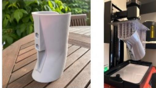
O cesto que fica colocado dentro do contentor e que recebe os dejetos é injetado e fabricado em polipropileno que oferece boa resistência ao impacto, boa estabilidade térmica, baixo custo e permite a reciclagem do plástico, características importantes para um bom desempenho do contentor final (Savini, 2020).
