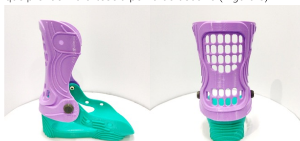
Figura 4. Modelo final da órtese AFO infantil impressa em 3D. Fonte: Próprios Autores.
