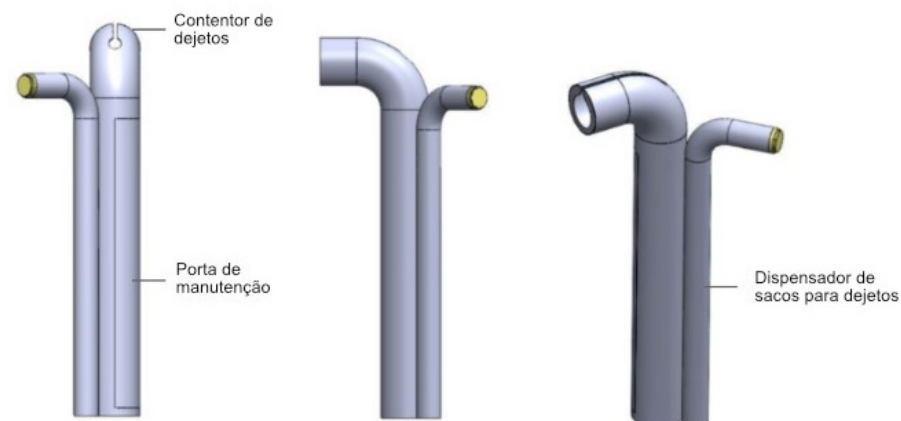
Figura 1. Modelação 3D do contentor, dispensador e porta de manutenção Fonte própria, 2022
