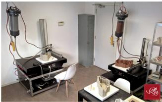
Figura 9. Impressoras 3d de cerâmica da marca holandesa Lutum. Fonte: VORMON3DPRINTING, 2016.
