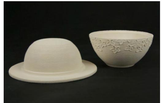
Figura 10. Objetos em cerâmica produzidos a partir da impressão 3d. Fontes: HERPT, 2012; HUSON, 2012.
