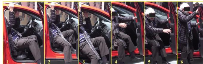
**Figura 10.** Posição de saída (rotação do dorso sobre o assento, necessidade de apoios de braços).
