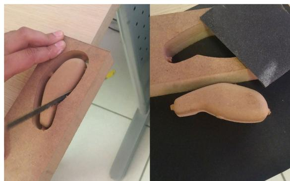
Figura 8. Remoção das pontes de usinagem
