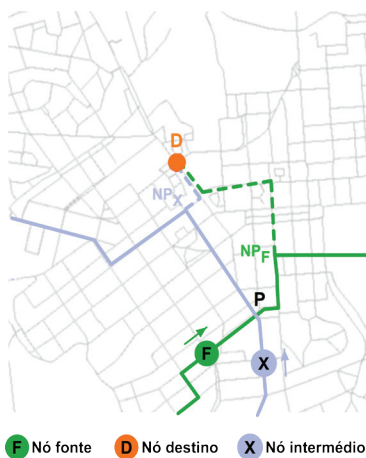
Fig. 7. Princípio de funcionamento do protocolo GeOpps.
