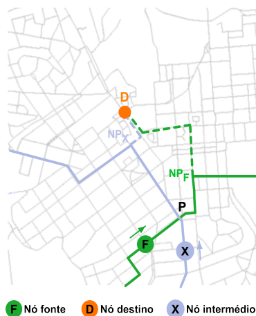
Fig. 7. Princípio de funcionamento do protocolo GeOpps.
