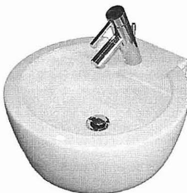
Os resultado final pode ser rapidamente antevisto recorrendo a sistemas de prototipagem rápida. [Modelo LOM esmaltado, realizado por INEGI para CIFIAL SA] Nota: Imagem obtida com diferente distância focal, que origina um maior efeito de perspectiva.
