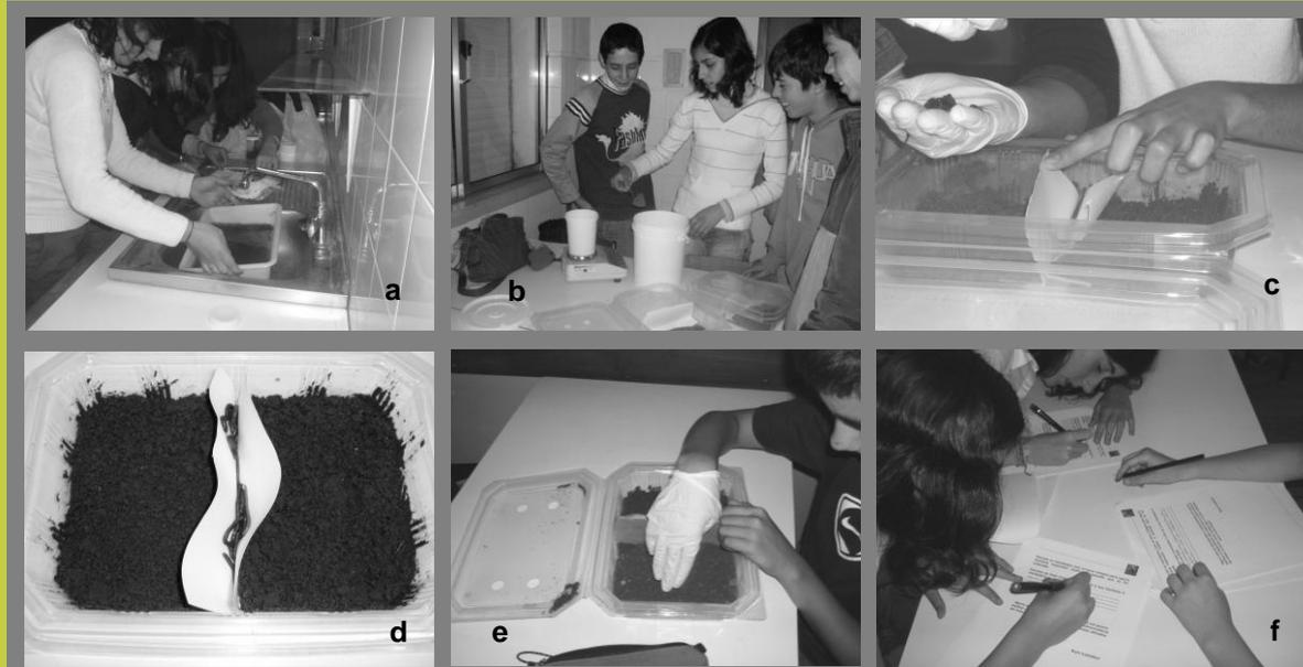
FIGURA 6: Imagens ilustrativas da realização do ensaio de evitamento pelos alunos. a) lavagem das minhocas; b) pesagem dos solos; c-d) colocação das minhocas nas caixas do ensaio; e) contagem das minhocas no fim do ensaio; f) análise e discussão dos resultados com o apoio do guião do aluno.
