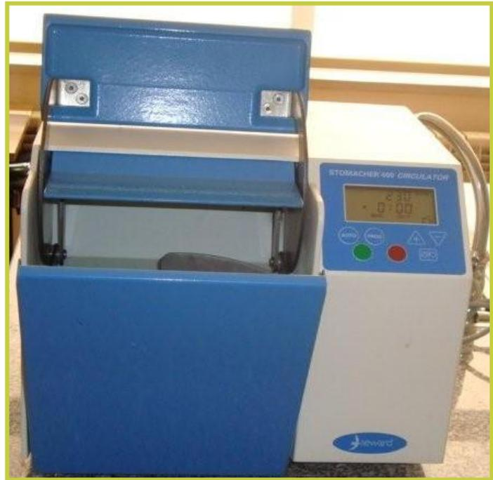
FIGURA 5: Foto do liquidificador Stomacher onde se efectua a homogeneização de alimentos sólidos.
