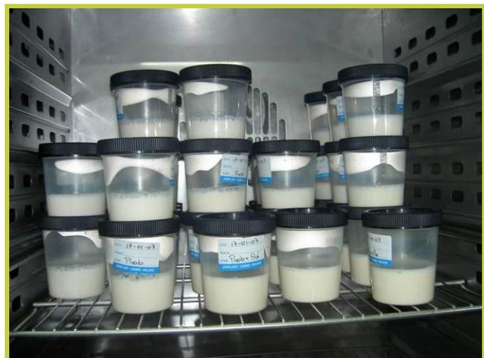
FIGURA 4: Foto dos frascos com as porções de matrizes após coagulação.
