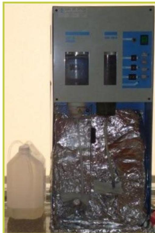
FIGURA 6: Destilador para análise de azoto pelo método de Kjeldahl.
