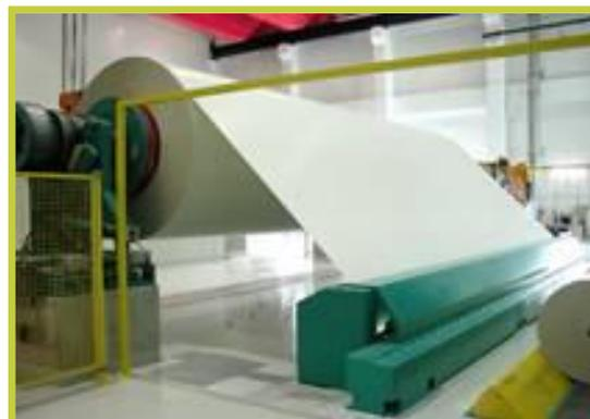
FIGURA 4: O controlo da espessura do papel é feito *on line*, durante o processo de fabrico, com uma fonte radioactiva.
