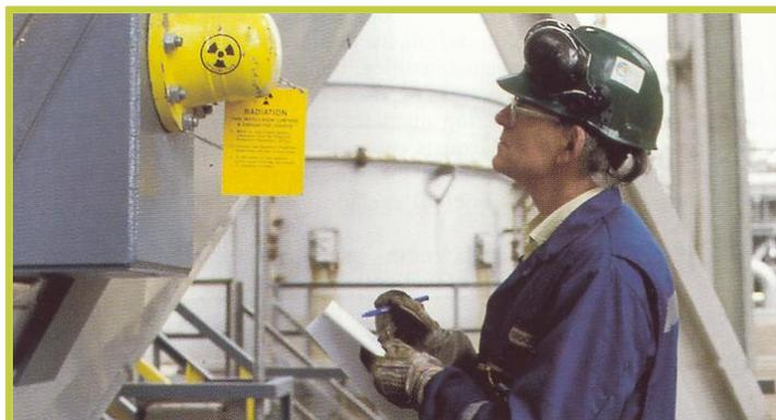
FIGURA 3: Controlo de enchimento de um silo com uma fonte radioactiva.
