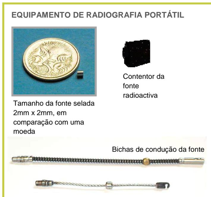
FIGURA 2: Equipamento de radiografia industrial com uma fonte radioactiva de emissão de radiação gama (gamagrafia). Crédito: AIEA.
