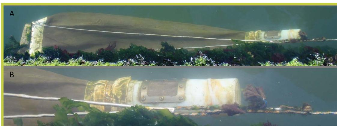
FIGURA 2: A. Rede de plâncton usada para a captura das megalopas selvagens de *Carcinus maenas* na Ria de Aveiro. B. Copo coletor onde a amostra de plâncton fica retida. (Fotografia: Felisa Rey).
