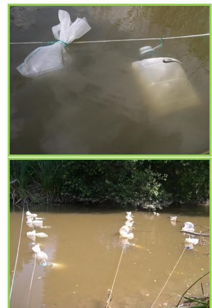
FIGURA 8: Colocação das câmaras controlo e de teste nos ensaios *in situ*.
