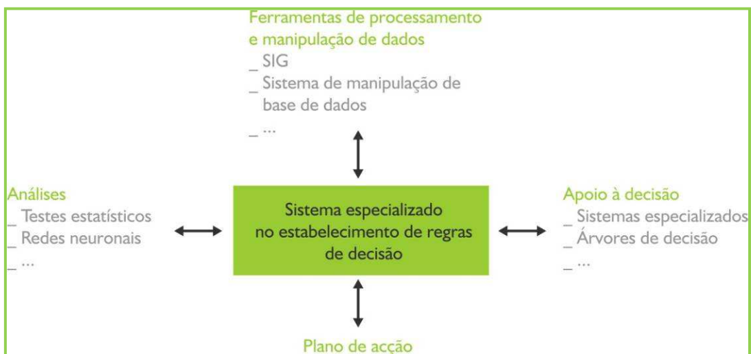
FIGURA 4: Esquema explicativo de um sistema especializado no estabelecimento de regras de decisão. O sistema informático segue determinadas regras, conferidas por um vasto grupo de ferramentas de processamento de dados, ferramentas de análise e de apoio à decisão, traçando por fim um plano de acção sobre o qual o utilizador vai desenvolver o seu trabalho. Adaptado de Johnston (1998).
