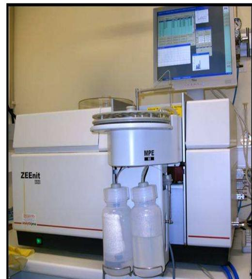
FIGURA 3: Espectrómetro de absorção atómica com atomização em forno de grafite.
