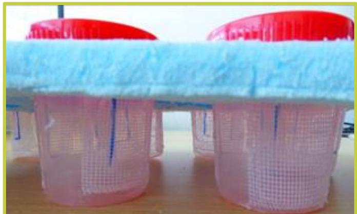
FIGURA 3: Câmaras desenvolvidas para ensaios *in situ* com *Physa acuta*. Salienta-se o pormenor das duas aberturas laterais em rede mosquiteira, permitindo a passagem da água e a placa de poliestireno usada para garantir a fluutuabilidade das câmaras.
