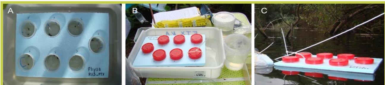
FIGURA 7: A e B - Placa de poliestireno com as câmaras de ensaio; C- Estrutura instalada no rio e presa à margem com cabo de nylon.
