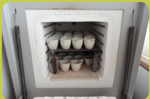
FIGURA 6: Mufla utilizada para a queima da matéria orgânica através da técnica de perda de peso por ignição.
